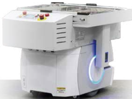
AMR을 이용한 SMT 생산라인 자동화 시스템
